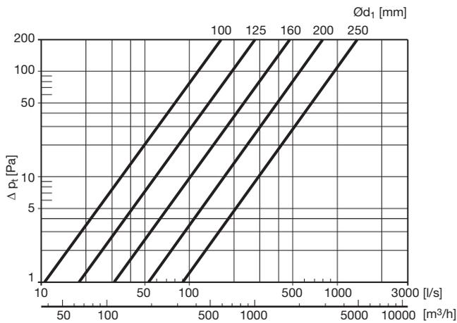
Das Diagramm zeigt den Druckverlust bei einem Reinigungsbogen mit Deckel (KCU oder EPFH). Der Druckverlust ist unabhängig von der Abgangsgröße ( $\text{O}d_3 \leq \text{O}d_1$ ).
