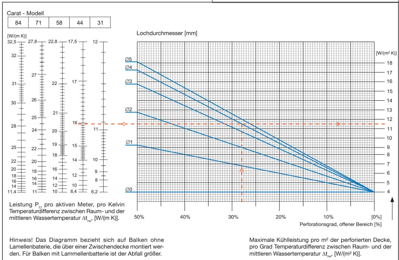
Diagramm 1: Spezifische Kühlleistung  $P_{Lt}$  bei der Montage über einer perforierten Zwischendecke.
