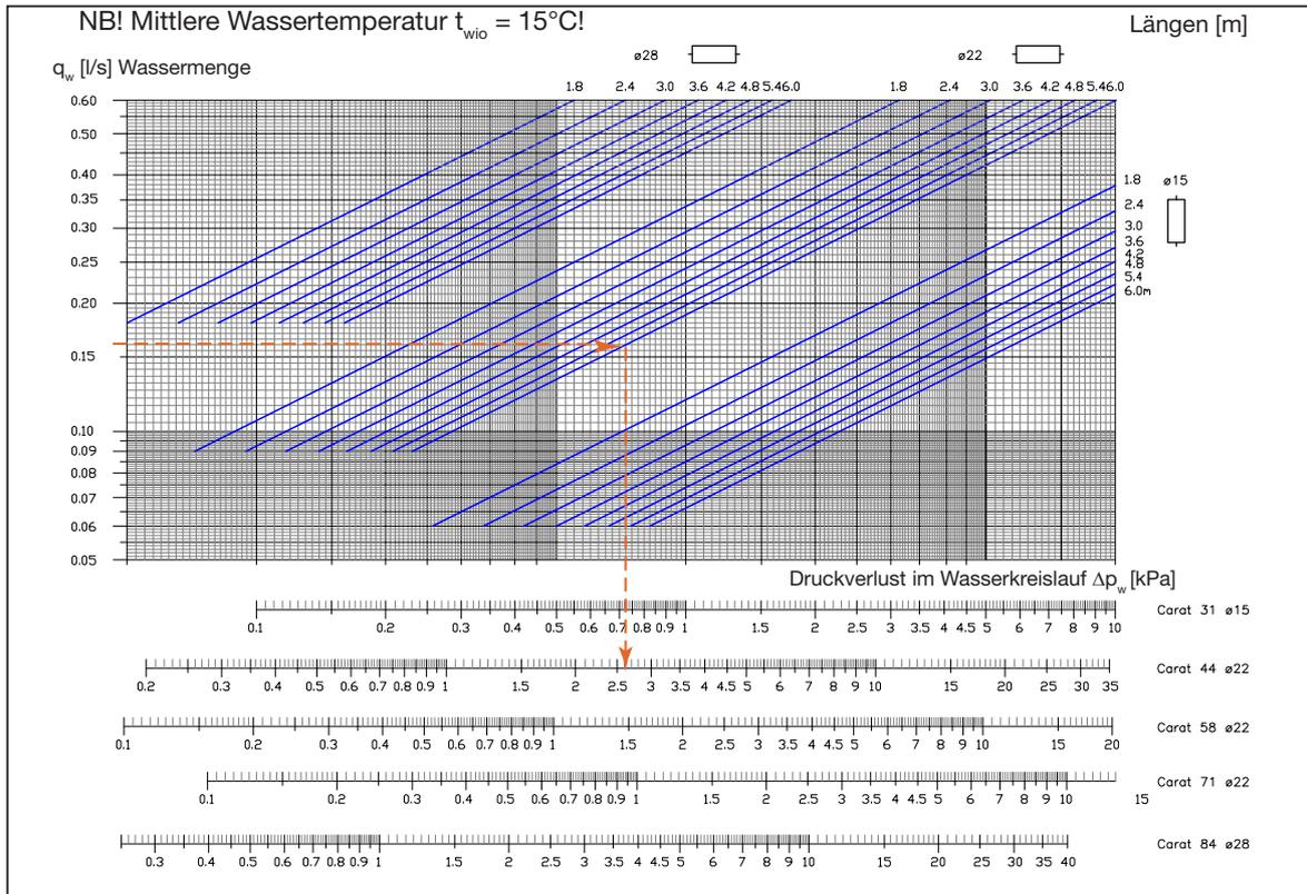
Diagramm 5: Druckverlust im Wasserkreislauf  $\Delta p_w$  für Carat Verbindungsoption "13".
