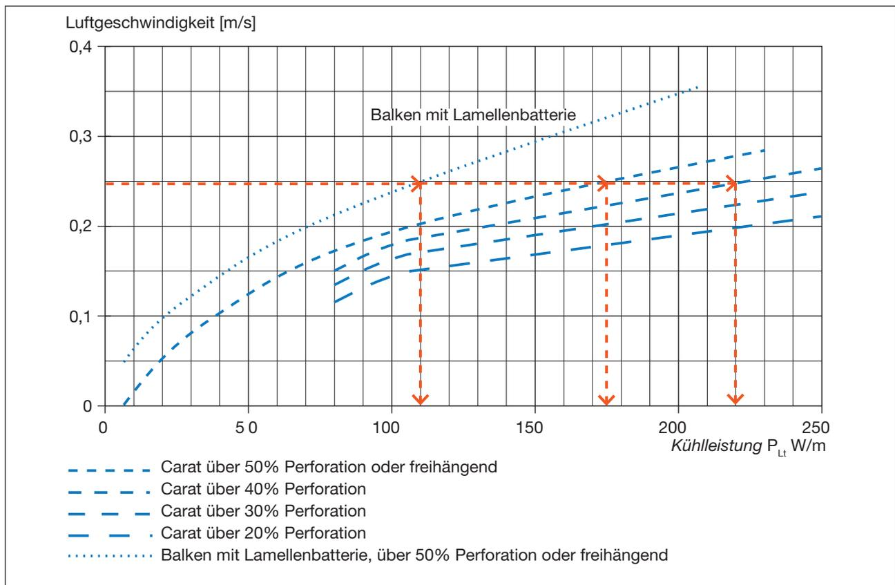
Diagramm 3: Luftgeschwindigkeit als Funktion der Kühlleistung bei Kühlbalken.
