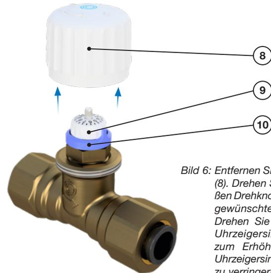
Bild 6: Entfernen Sie die Kappe (8). Drehen Sie den weißen Drehknopf (9) bis zur gewünschten Position. Drehen Sie gegen den Uhrzeigersinn (CCW) zum Erhöhen und im Uhrzeigersinn (CW), um zu verringern.
